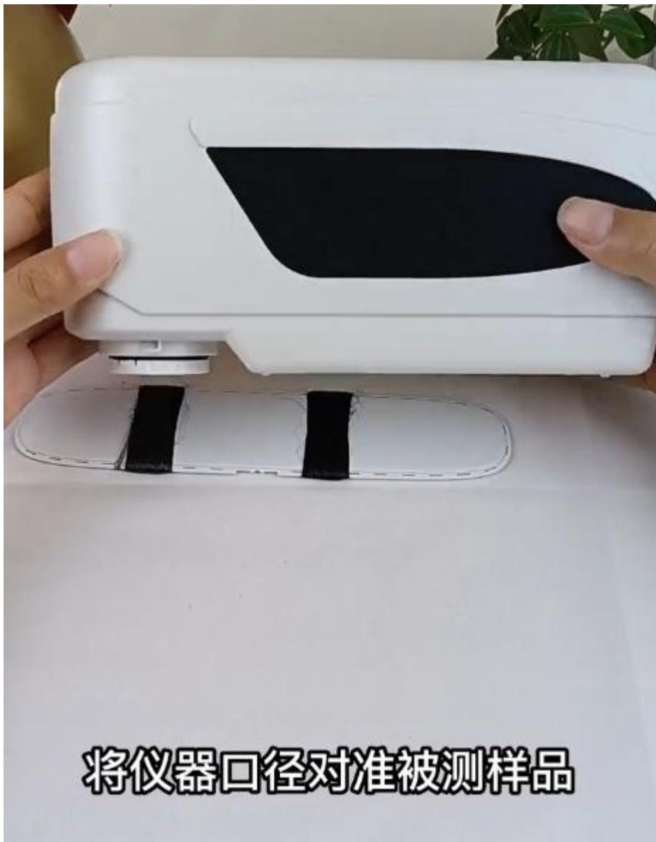
**将仪器口径对准被测样品**
