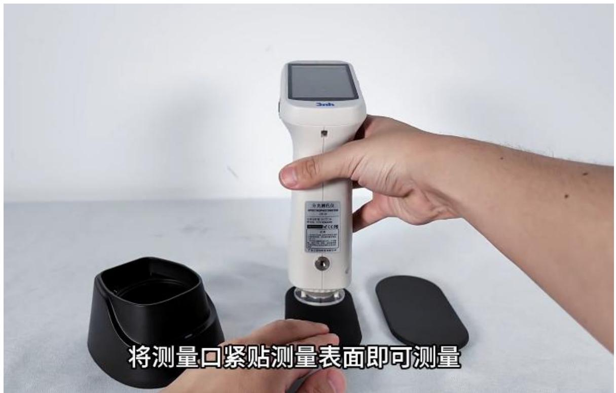
测量角度遵循标准的  $45^\circ / 0^\circ$  或  $0^\circ / 45^\circ$  或 D/8 几何条件，保证测量数据的准确性和可比性。
