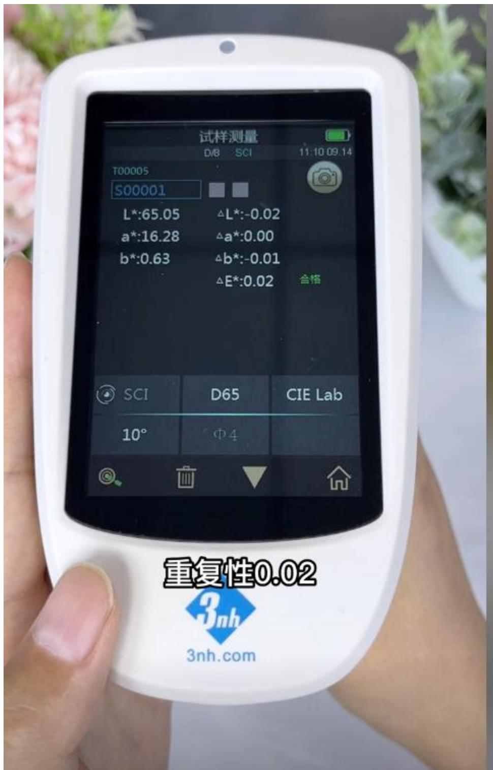
分光测色仪TS7600可精确测量涂料样品的SCI、SCE反射率数据，在多种颜色空间下，能够对各种色差公式、颜色指数进行准确测量和表述。仪器自带多本标准电子色卡，无需携带厚重的色卡，支持快速准确检索，即时输出匹配色卡编号。借助泰双TS7600分光测色仪可轻松实现颜色的精确传递，也可做为准确配色系统的检测设备。
