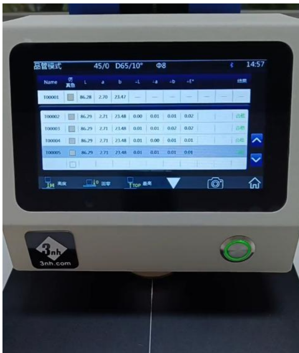
TS7700 分光测色仪测量铝板颜色
