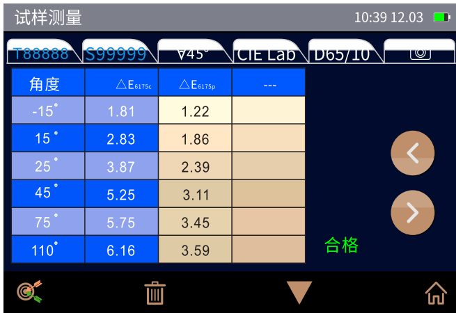
图50 试样测量时使用 \Delta E_{6175} 计算色差
