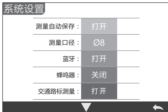
图12 系统设置中“交通路标测量”选择“打开”
