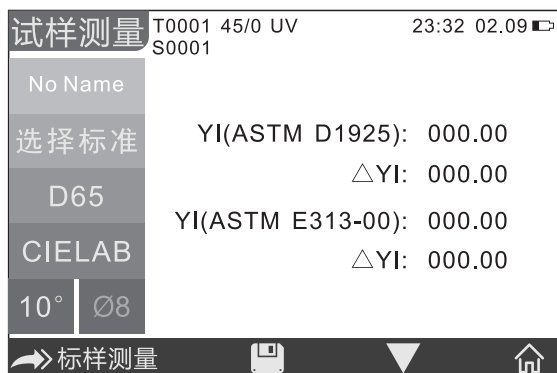
图43 试样测量界面下的黄度指数界面
