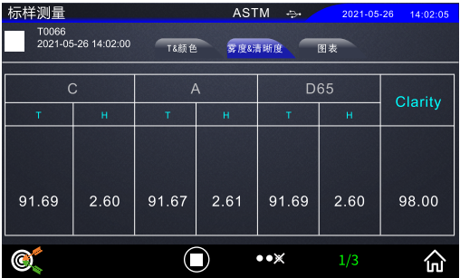
图31 第一次标样平均测量完成
