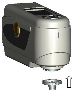
图 12 加长测量口径对准安装孔位
