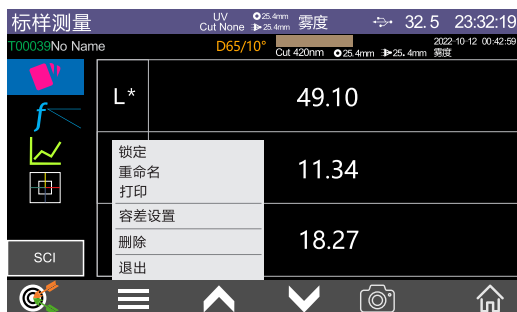
图 33 打印操作界面
