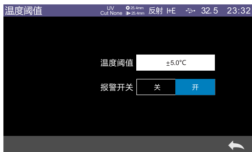
图 70 温度阈值设置界面
