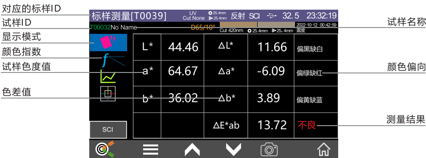
图 17 试样测量界面
