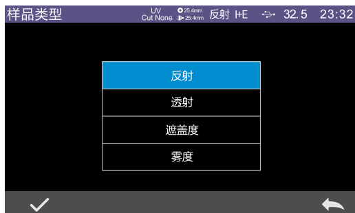
图 49 透反射模式选择界面
